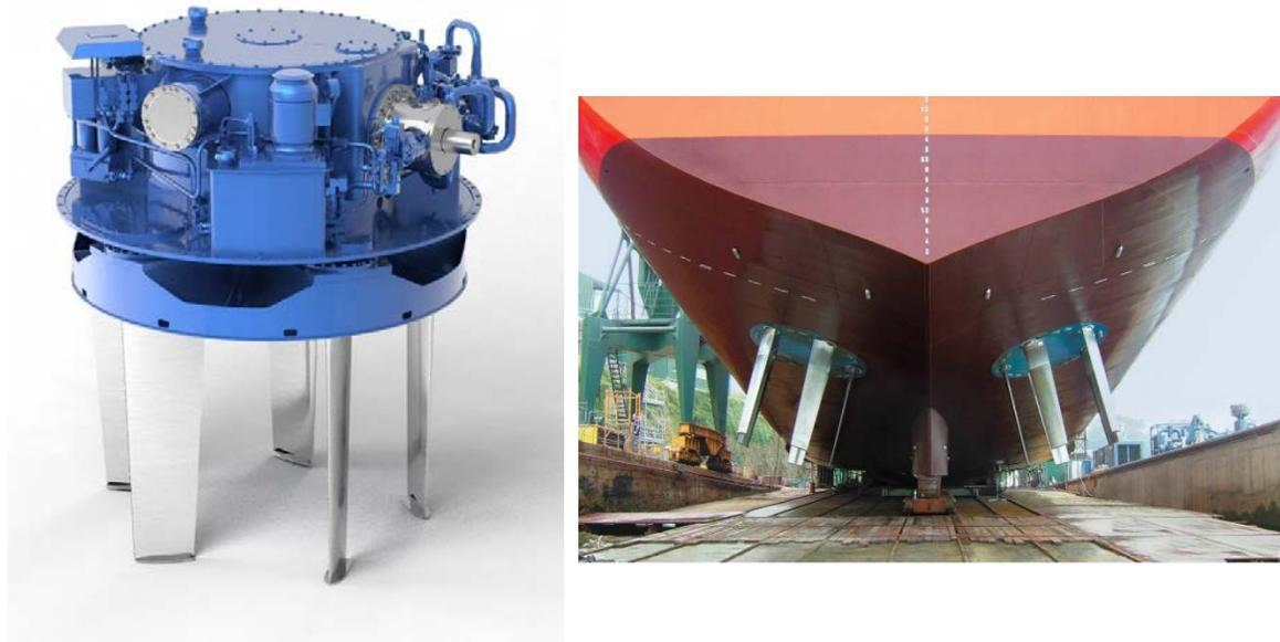
**Fig. 1 Voith Schneider Propeller (VSP)**
